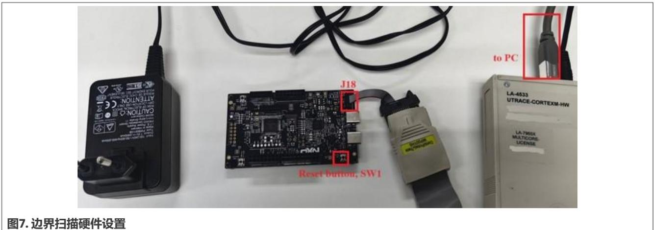
2. 通过USB电缆将μTrace for Cortex-M调试器连接到PC，然后使用5V电源适配器给调试器上电。在PC上打开“设备管理器”。如图8所示，Lauterbach设备出现在Trace32设备中。如果未出现，请检查连接。
