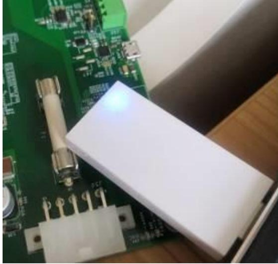
图29. 将NFC读写器放在数字板NFC天线上
