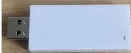
图27. 硬件包中包含的默认GMMC Pocket NFC CCID 0读写器
