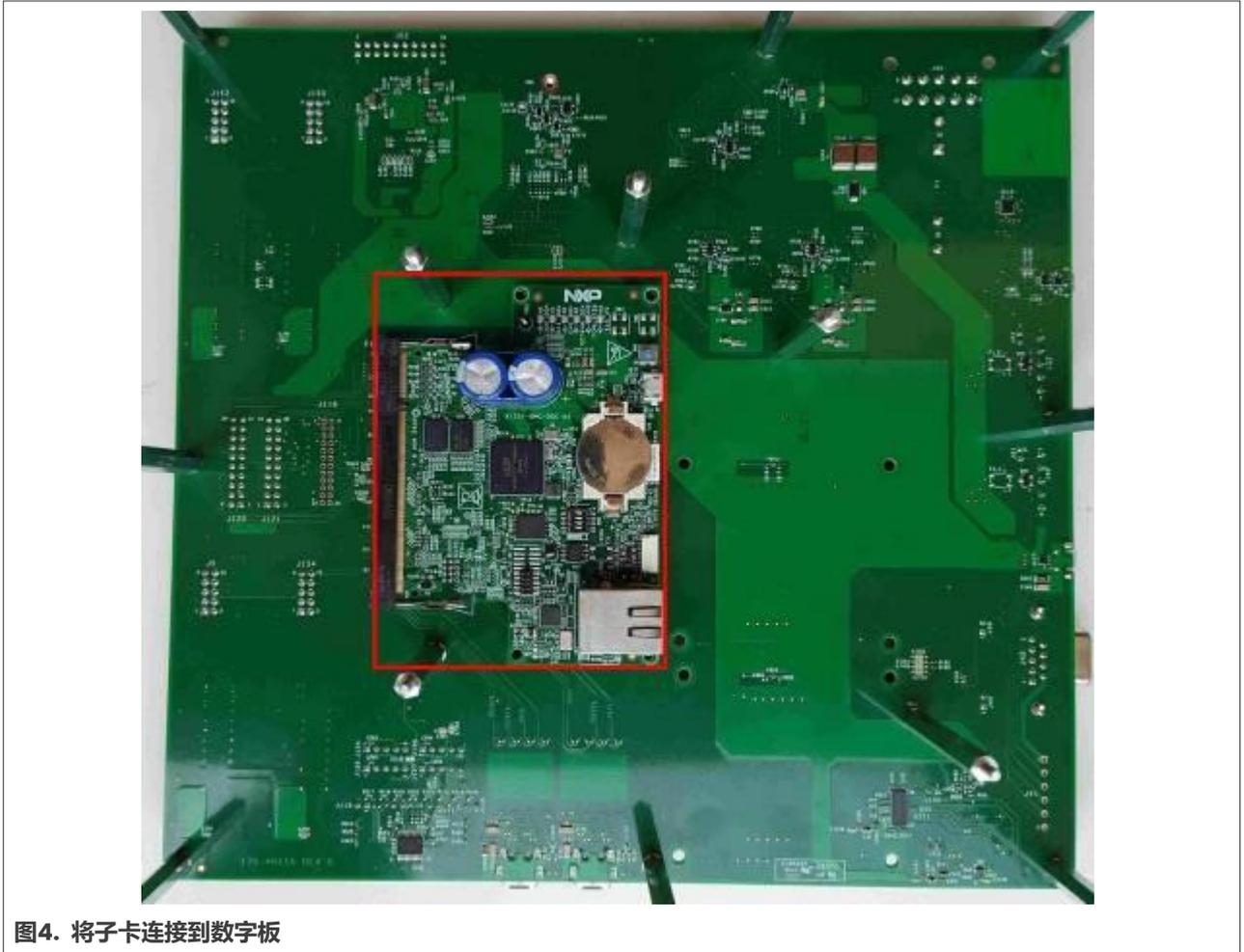
图4. 将子卡连接到数字板
