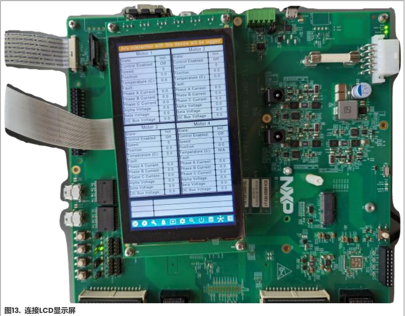
图13. 连接LCD显示屏
