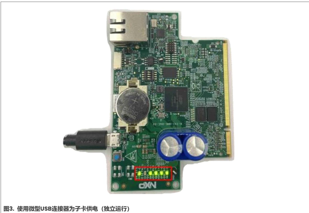
图3. 使用微型USB连接器为子卡供电（独立运行）
