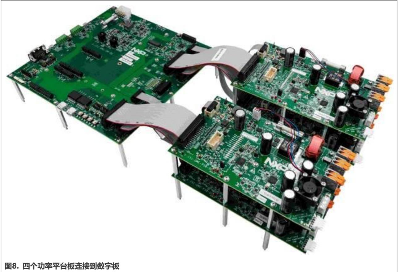
图8. 四个功率平台板连接到数字板
