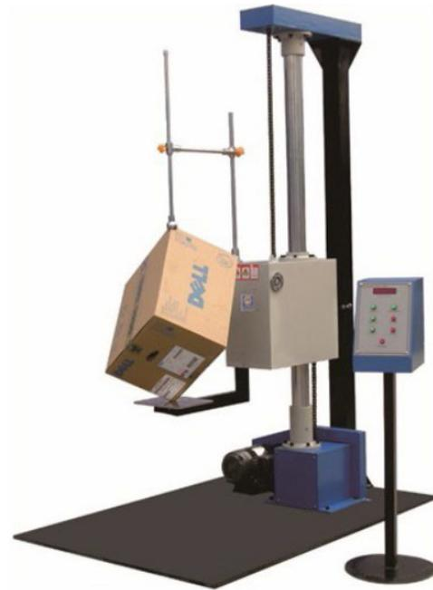
図6: 落下テストマシン
