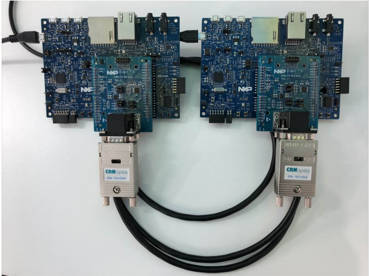
图 2. 电路板设置和 CAN 连接
